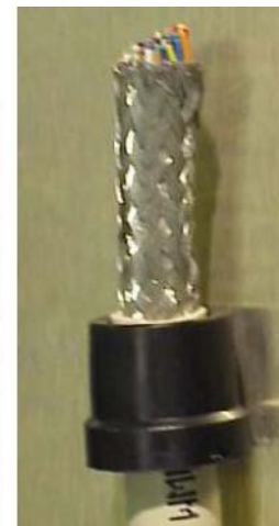
Abb. 7. Metallumflochtene Hydraulikleitung, Spiral-Gasanschlusschlauch und umflochtenes, abgeschirmtes Kabel sind jeweils gut geeignet für die EMV-Abschirmung des fünfadrigen Sensoranschlusses.
