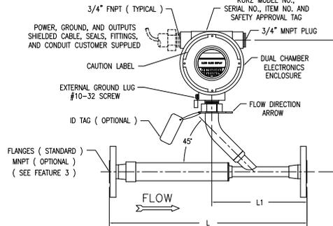
**DIRECTLY ATTACHED ELECTRONICS ENCLOSURE ( TA )**
